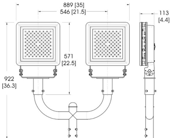
Support de pose installé en usine
