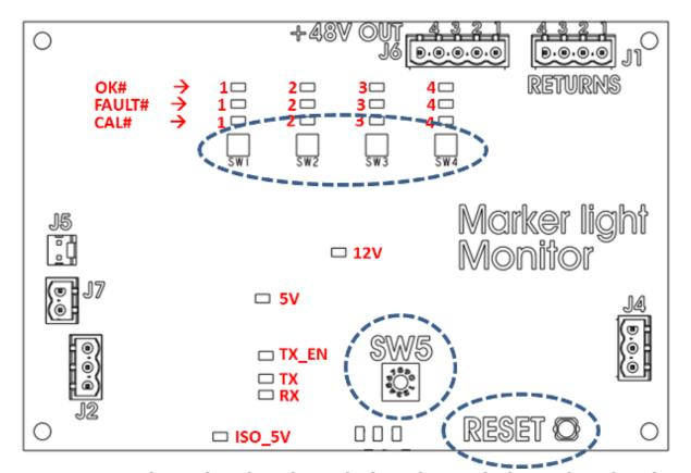
MARKER LIGHT MONITOR BOARD SHOWING BUTTONS AND SWITCH FOR CONFIGURATION AND CALIBRATION
