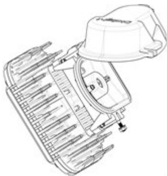
Afbeelding 10 - Het armatuur op de kolomsteun bevestigen
