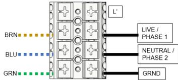
Nach unten drücken, Stromleiter einsetzen und loslassen
