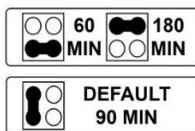
Jumper-Positionen für Batteriekonfiguration
