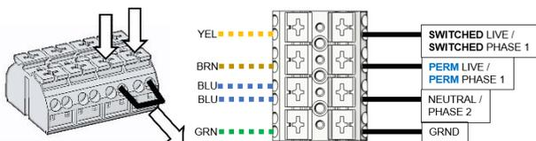
Nach unten drücken, Jumper **entfernen** und loslassen
