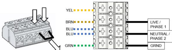
Nach unten drücken, Jumper **entfernen** und loslassen
