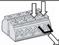
Nach unten drücken, Jumper **entfernen** und loslassen
