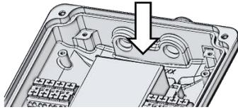
Nachdem Sie die Funktion der Leuchte überprüft haben, überschüssiges Kabel in der Leuchte verstauen
