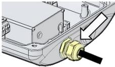
Zugentlastung laut Empfehlung des Herstellers der Kabelverschraubung festziehen, um Kabel zu fixieren
