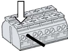
Nach unten drücken, Stromleiter einsetzen und loslassen
