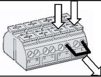
Nach unten drücken, Jumper **entfernen** und loslassen
