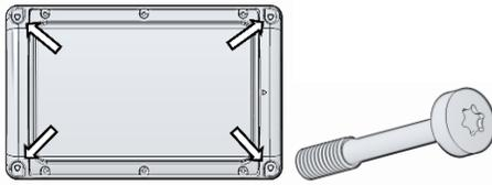
Unverlierbare Schrauben an den Ecken lösen
